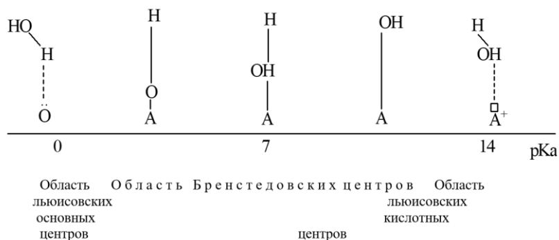
Рис. Кисотно-основная схема частично дегидратированной поверхности твердого оксида
