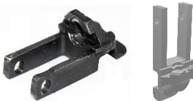
Рис. 2. Сопоставление детали образца стрелкового оружия с его 3D-моделью
