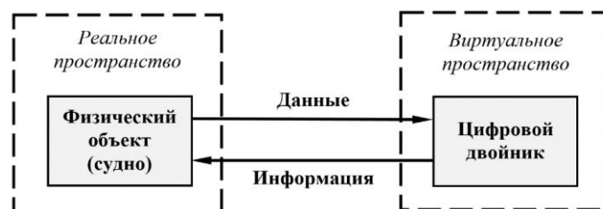
Рис. 1. Простейшая визуализация концепции цифрового двойника
